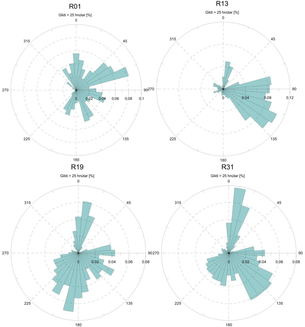
Mynd 13 Brautarmælar. Vindrósir fyrir 2 mín meðalvindhraða yfir 25 hnútum. Kvarðinn sýnir hlutfall af tímanum sem vindur er innan vindgeira. Athuga skal að kvarði er mismunandi milli mynda.
