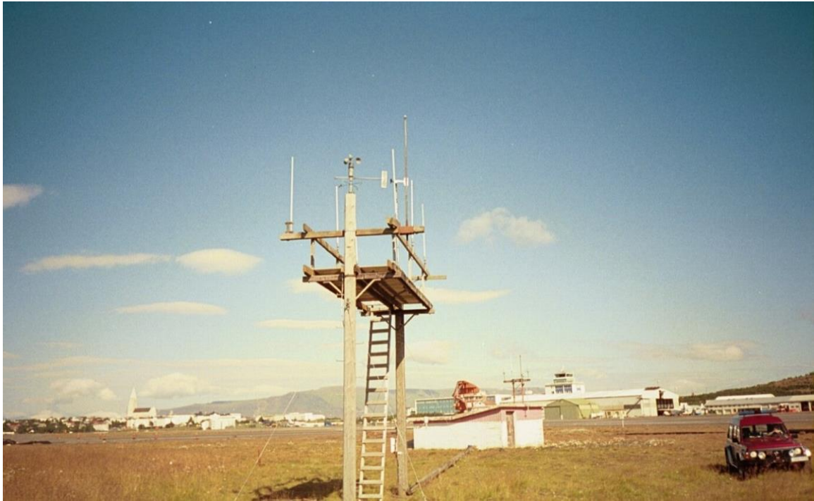
Mynd 2. Vindhraðamælir á radareyju fyrir hækkun mælis.
